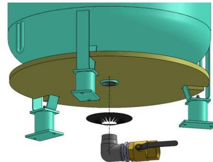
Mettre en place le disque d'isolant sous l'appareil et le maintenir à l'aide du raccordement de la vidange et de la rosace de fixation.
