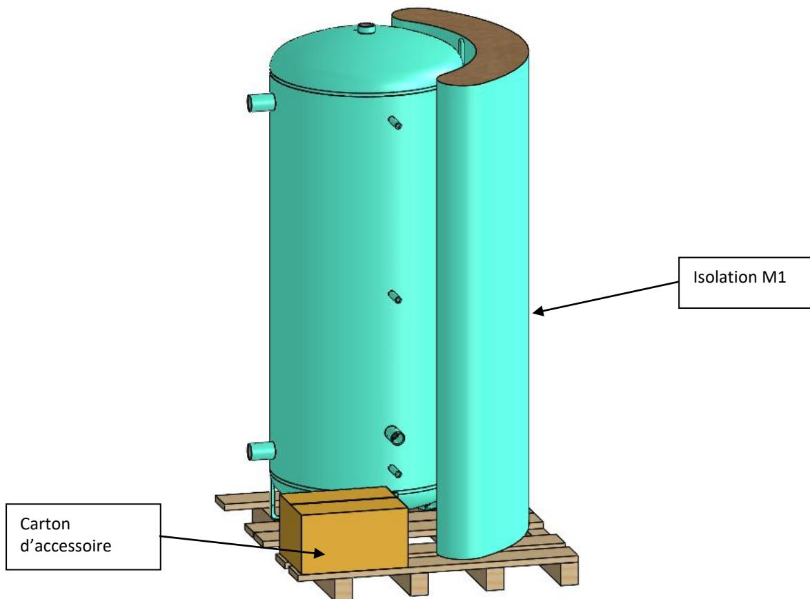
Les appareils sont livrés en position verticale sur socle bois.
